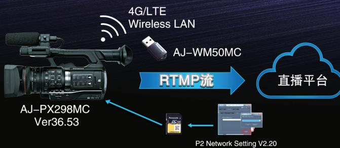
RTMP即Real Time Messaging Protocol（实时消息传输协议）是目前各种网络直播平台普遍采用的直播流传输模式。PAD、手机、电脑可直接实时观看视频直播内容，并可参与直播、点播。
